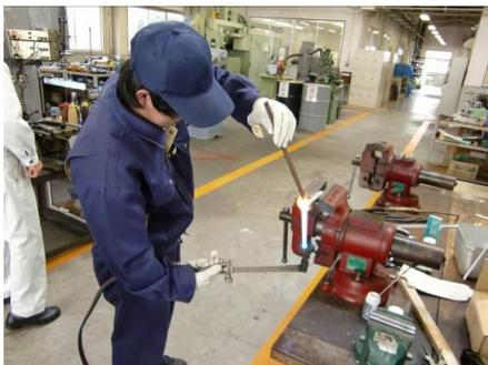
図4 超鋼ロウ付けバイトの製作
